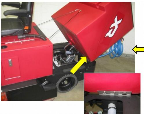
В конструкции поломоечной XR используются большие шарнирные соединения (длина – 20 см) из нержавеющей стали, непосредственно присоединенные с помощью болтов к прочнейшей стальной раме. Этим достигается прочность, недоступная для большинства машин, в которых использованы шарниры меньшего размера, прикрепленные к пластиковым бакам.
