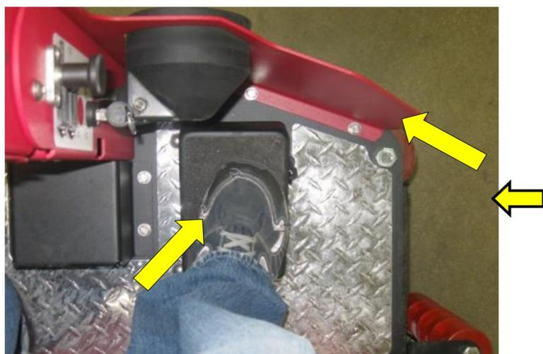
Для контроля скорости поломоечной машины XR используется большая удобная педаль. На фотографии Вы также можете видеть кожух, который обеспечивает защиту ног оператора. Полностью закрывающий переднюю часть машины, этот кожух исключает возможность травм, которые нередко случаются, когда ноги оператора выступают за габариты машины.
