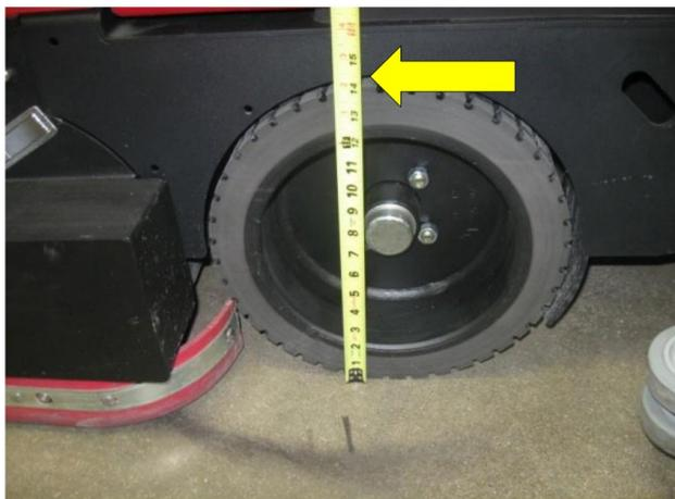
Диаметр колёс поломоечной машины XR составляет 35 см. Это значительно облегчает движение машины по неровным бетонным полам и позволяет преодолевать пороги и другие препятствия. Каждое колесо способно выдержать нагрузку до 1500 кг, что втрое превышает давление на колесо, возникающее при полностью заполненных баках машины.
