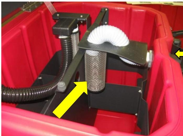
Одной из уникальных особенностей XR является фильтр из нержавеющей стали, который задерживает мусор, содержащийся в грязной воде. Благодаря этому, обеспечивается защита от засорения канализационной системы, куда обычно сливается собранная вода. Таким образом, простейшее устройство, позволяет избежать существенных затрат на прочистку труб.
