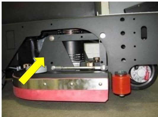
В конструкции полумоечных машин XR использованы прочнейшие стальные рычаги и щёточные узлы, способные противостоять даже сильным ударам, в отличие от машин с пластиковыми тягами и алюминиевыми щёточными узлами. Кроме того, любая поломка может быть устранена на месте, без какого-либо специального оборудования.
