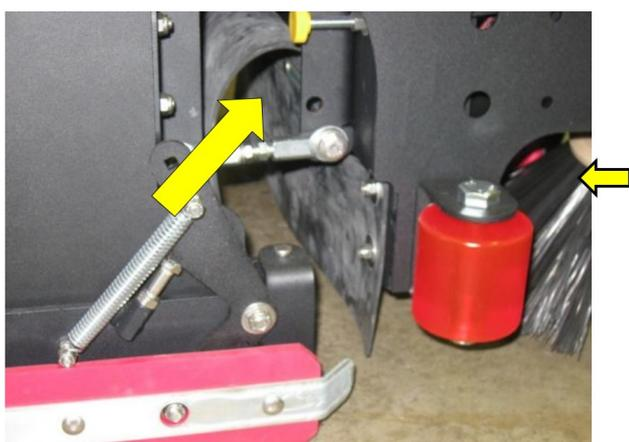
В отличие от большинства других полумоечных машин, XR оснащён специальным кожухом, препятствующим попаданию воды и грязи на щёточный узел.
