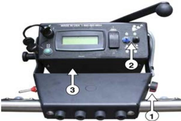
1. Раздельное управление скоростью и направлением движения значительно облегчает работу с машиной, даже для неопытного оператора. Такая система полностью исключает скачок скорости при поворотах
