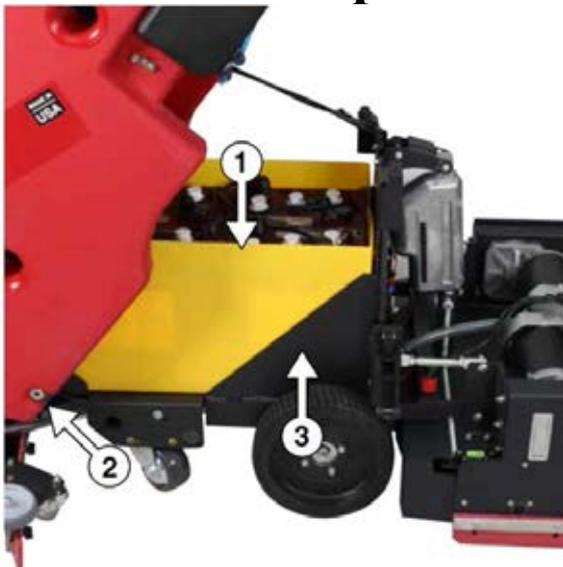
1. Пластиковый контейнер, в котором размещены высококачественные аккумуляторы Trojan, защищает машину от возможных протечек кислоты
