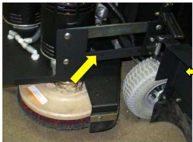
Рычаги и другие компоненты щёточных узлов поломочной машины MiniMag изготовлены из прочнейшей стали со специальным защитным покрытием. В отличие от машин, в которых для этого использован пластик и алюминий, они способны выдерживать даже очень сильные удары. Кроме того любая поломка может быть устранена на месте без какого-либо специального оборудования.
