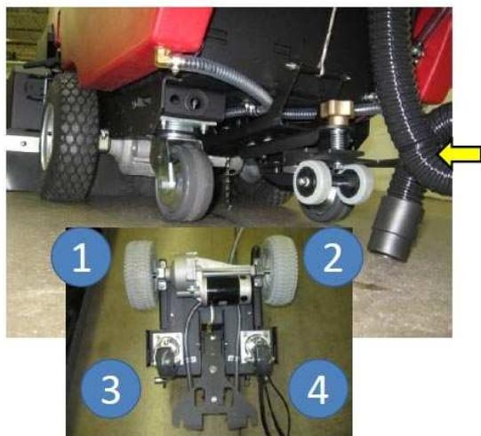
Поломоечная машина MiniMag имеет 4 точки опоры (вместо 3 как у большинства других машин). Эта особенность позволяет машине плавно и устойчиво передвигаться по неровным поверхностям и не терять равновесия при поворотах.
