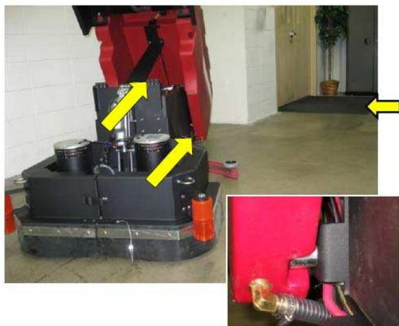
В конструкции полумоечной машины MiniMag отсутствует жёсткое закрепление бака на раме машины. Это значительно снижает риск повреждений шлангов и электрических проводов. Баки машины изготовлены из высокопрочного пластика и могут легко и плавно откидываться, благодаря шарнирному соединению с рамой.
