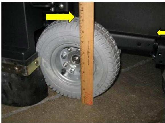
Поломоечная машина MiniMag оборудована шинами большого диаметра. Это значительно облегчает движение машины по неровным бетонным полам и позволяет преодолевать пороги и другие препятствия. Специальный рисунок протектора шин обеспечивает высокую силу сцепления с поверхностью и упрощает управление машиной.
