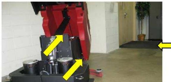
В конструкции поломоечной машины Magnum отсутствует жёсткое закрепление бака на раме машины. Это значительно снижает риск повреждений шлангов и электрических проводов. Баки машины изготовлены из высокопрочного пластика и могут легко и плавно откидываться, благодаря шарнирному соединению с рамой.
