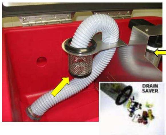
Одной из уникальных особенностей полумоечной машины Magnum является фильтр из нержавеющей стали, который задерживает мусор, содержащийся в грязной воде. Благодаря этому, обеспечивается защита от засорения канализационной системы, куда обычно сливается собранная вода. Таким образом, простейшее устройство позволяет избежать существенных затрат на прочистку труб.
