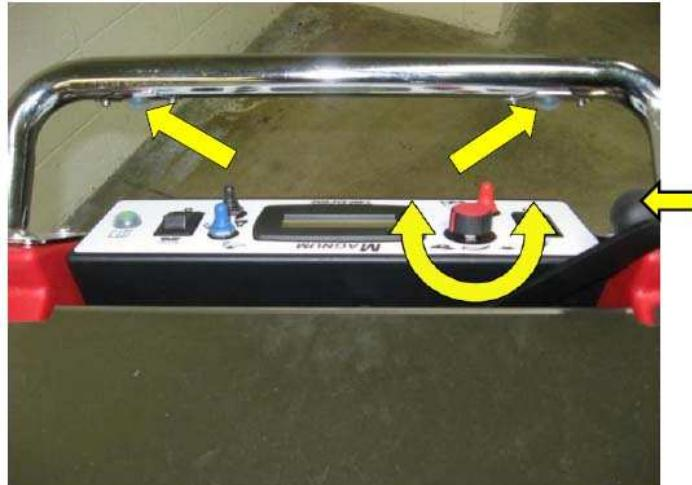
Раздельное управление направлением и скоростью движения позволяет даже новичкам уверенно управлять машиной. Кроме того, по нашему мнению, это существенно повышает безопасность работы, поскольку при такой системе усилие, прикладываемое для поворота машины не оказывает влияния на её скорость.
