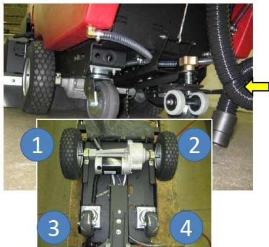
Поломоечная машина Magnum имеет 4 точки опоры (вместо 3 как у большинства других машин). Эта особенность позволяет машине плавно и устойчиво передвигаться по неровным поверхностям и не терять равновесия при поворотах.
