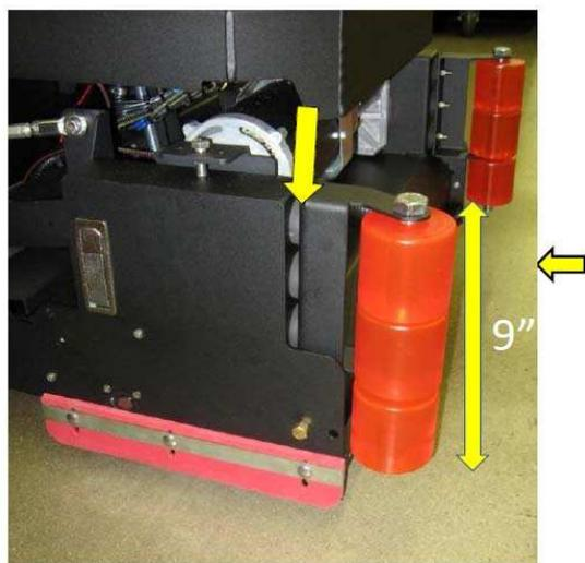
Щёточный узел полумоечной машины Magnum, оборудованной цилиндрическими щётками защищён полиуретановыми роликами. Благодаря этой уникальной особенности обеспечивается защита как машины, так и стен помещения.
