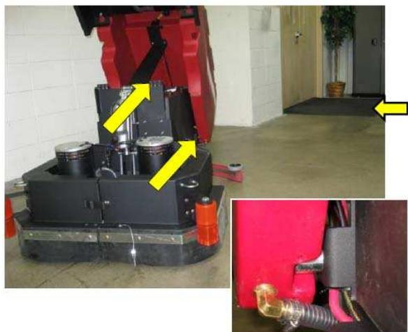
В конструкции поломоечной машины Magnum отсутствует жёсткое закрепление бака на раме машины. Это значительно снижает риск повреждений шлангов и электрических проводов. Баки машины изготовлены из высокопрочного пластика и могут легко и плавно откидываться, благодаря шарнирному соединению с рамой.
