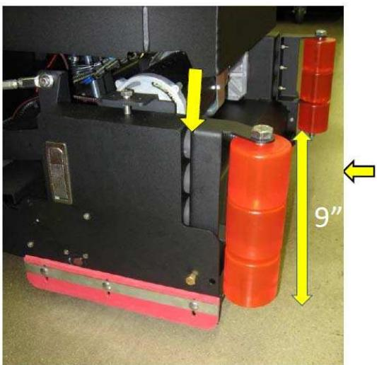
Щёточный узел поломоечной машины Magnum, оборудованной цилиндрическими щётками защищён полиуретановыми роликами. Благодаря этой уникальной особенности обеспечивается защита как машины, так и стен помещения.
