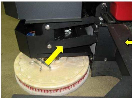
Рычаги и другие компоненты щёточных узлов поломоечной машины Magnum изготовлены из прочнейшей стали со специальным защитным покрытием. В отличие от машин, в которых для этого использован пластик и алюминий, они способны выдерживать даже очень сильные удары. Кроме того любая поломка может быть устранена на месте без какого-либо специального оборудования.
