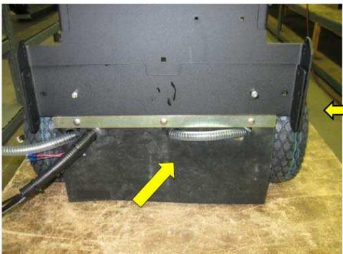
Специальный защитный кожух предохраняет ходовую часть машины от попадания воды, мусора и агрессивных моющих средств. Это существенно продлевает жизнь подшипников, прокладок и моторов.
