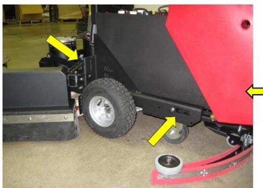
Прочнейшая стальная рама - основной элемент конструкции машины, который обеспечивает её высочайшую надёжность. К раме с помощью болтов присоединены все компоненты машины (колёса, трансмиссия, щёточный узел, крепление задней стяжки, стальные защитные кожухи и др.).
