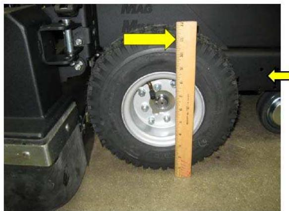
Поломоечная машина Magnum оборудована шинами большого диаметра. Это значительно облегчает движение машины по неровным бетонным полам и позволяет преодолевать пороги и другие препятствия. Специальный рисунок протектора шин обеспечивает высокую силу сцепления с поверхностью и упрощает управление машиной.
