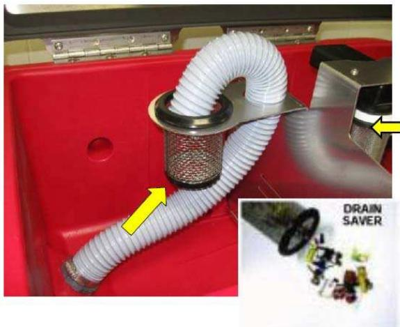
Одной из уникальных особенностей поломоечной машины Magnum является фильтр из нержавеющей стали, который задерживает мусор, содержащийся в грязной воде. Благодаря этому, обеспечивается защита от засорения канализационной системы, куда обычно сливается собранная вода. Таким образом, простейшее устройство позволяет избежать существенных затрат на прочистку труб.
